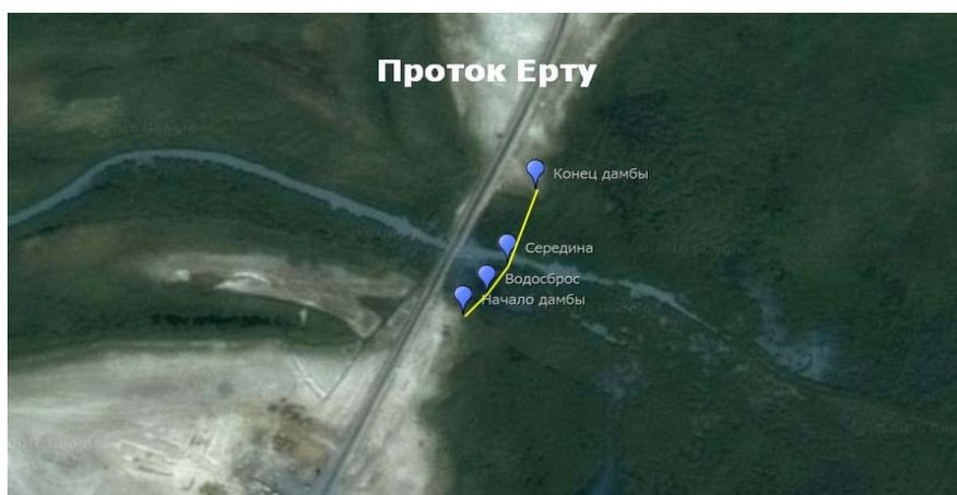
Рисунок 3 – Линия преграждающей дамбы через протоку «Ерту»
