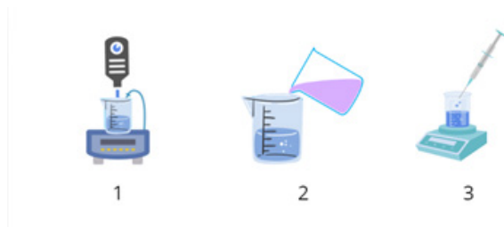
Рисунок 1 – Принципиальная схема получения микрокапсул по методу А. Имброньо, Э. Пьячентини, Э. Дриоли, Л. Джорно
