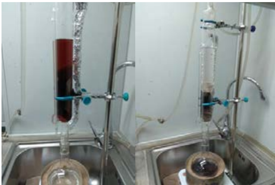
Сурет 4. Экстракциялау әдісі арқылы фуллеренді бөліп алу (Fig. 4. Fullerene separation by extraction)
