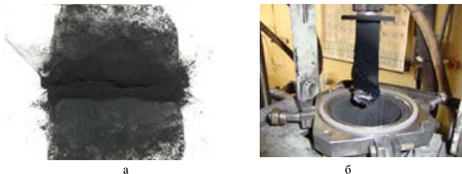
Сурет 2. фуллерен күйесі (а) және катодтағы депозитті материал (б) (Fig. 2. Fullerene carbon black (a) and deposit material on the cathode (b))
