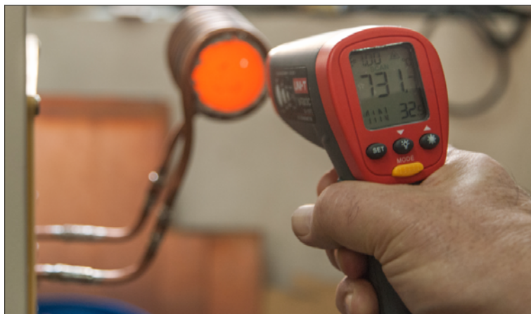
Рисунок 3 – Процесс индукционного нагрева металла до температуры 731°C
