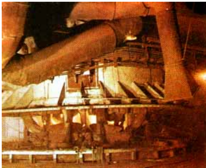
Рис. 3.1 Электродуговая печь и процесс получения МК на предприятии Bécancour Silicon Inc (см. текст)
