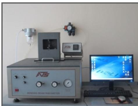
Рисунок 1. Реометр с изгибаемой балкой
