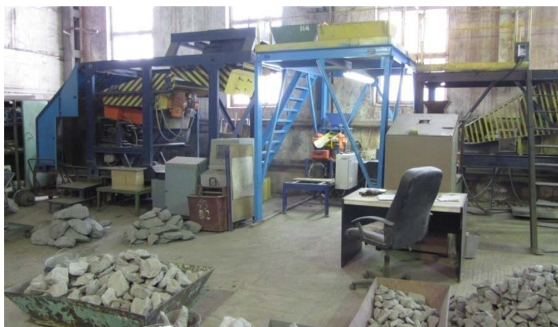
Рисунок 4 – Опытно-промышленный участок с сепараторами СРФ2-300 и СРФ1-100
