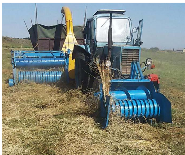
Рисунок 1 – Общий вид широкозахватного подборщика-измельчителя кормов ПИК-3,0 с тележкой на полях КХ «Жанико»
