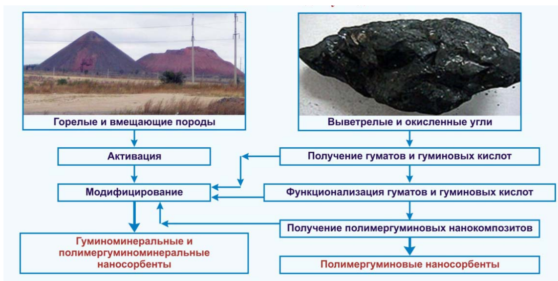
Рисунок 2 – Получение полимергуминоминеральных и полимергуминовых наносорбентов
