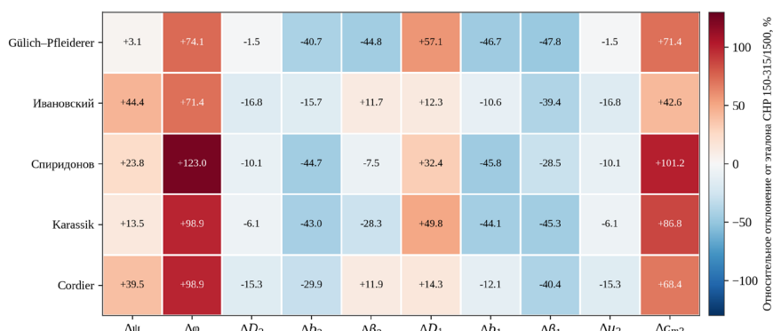
Рисунок 6. Карта относительных отклонений расчётных параметров рабочего колеса от фактических значений насоса СНР 150–315/1500.
