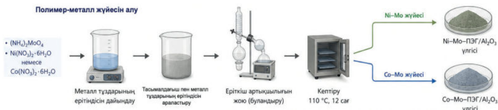
Сурет 1. Ni-Mo-ПЭГ/ \text{Al}_2\text{O}_3 және Co-Mo-ПЭГ/ \text{Al}_2\text{O}_3 полимер-металл функционалдық материалдарын алу сызбанұсқасы.
