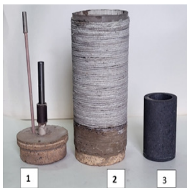
1- крышка, 2 – кварцевая трубка, 3 – графитовый тигель Рисунок 3 – Фотография изготовленного узла нагрева
