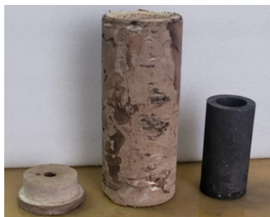
1- крышка, 2 – шамотный стакан, 3 – графитовый тигель Рисунок 4 – Фотография изготовленного второго варианта узла нагрева
