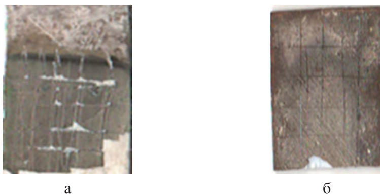
Рисунок 6 — Испытание адгезии гальванического никелевого покрытия методом решётчатых надрезов: а — обычное никелевое покрытие; б — никелевое покрытие, соответствующее требованиям стандарта ISO 2409-1992.
