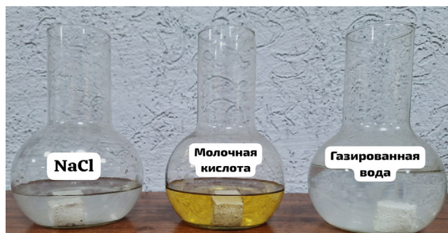
Сурет 1. Мырыш-фосфатты цементтің тәжірибелік үлгілері
