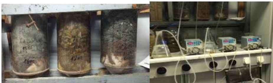
Рисунок 2 – Загруженные перколяторы для трех вариантов выщелачивания
