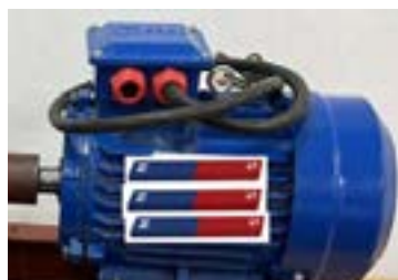
Сур. 3. Электргенератор корпусына жабыстырылған магниттер (Fig. 3. Magnets glued to the generator body)
