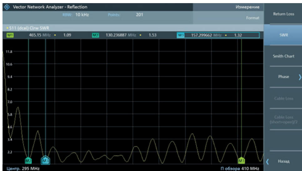
Рисунок 8. Результаты измерения коэффициента стоячей волны
