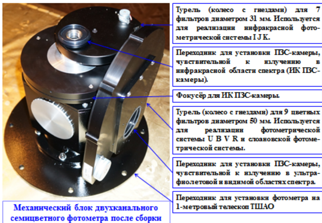
Рисунок 2 – Механический блок двухканального фотометра
