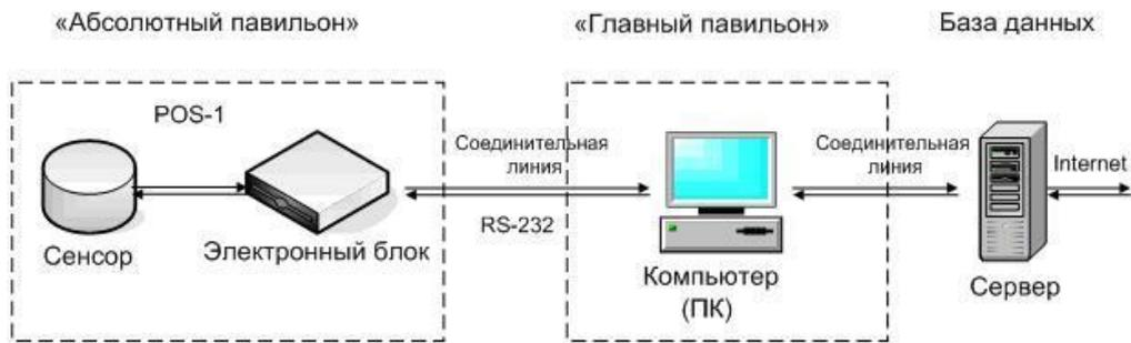
Рисунок 1 – Схема соединения аппаратуры
