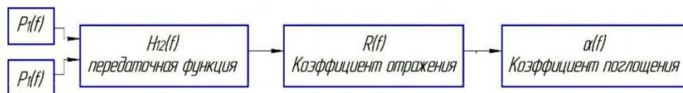
Рисунок 7 – Последовательность расчетов
