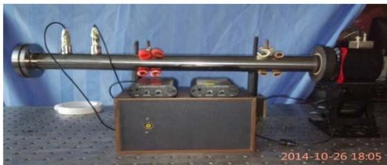
Рисунок 2 – Акустический интерферометр
