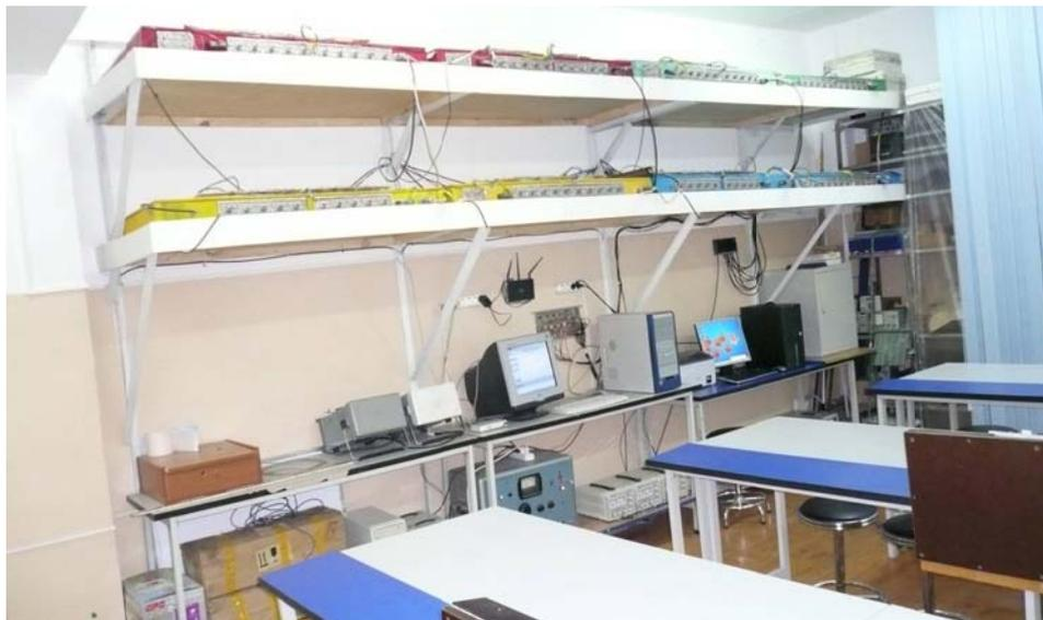
Рисунок 3 – Внешний вид экспериментальной установки для регистрации космических лучей
