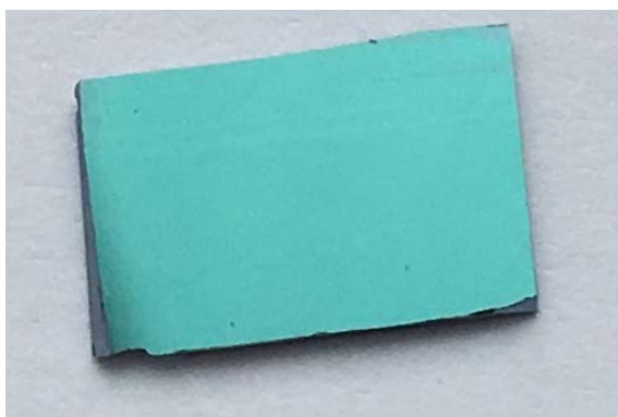
Рисунок 2 – Кремниевые подложки с никелевым катализатором до (слева) и после (справа) синтеза УНТ методом PECVD
