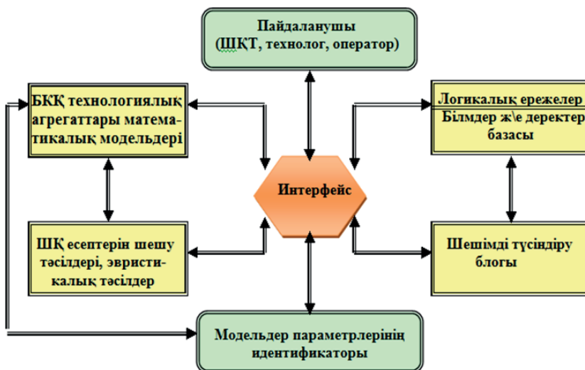
Сурет 1 – БКҚ жұмыс режимдерін басқару бойынша шешім қабылдауды қолдау жүйесінің құрылымы.
