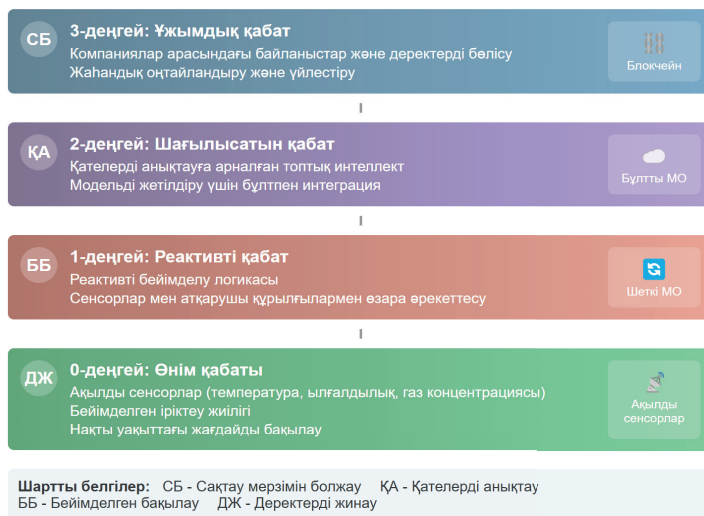
Сурет 8 — Азық-түлік өніміне арналған цифрлық егіздің көп деңгейлі архитектурасы.
