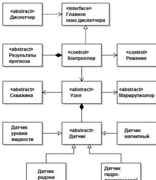
Рисунок 1 – Объектная модель системы мониторинга сейсмического состояния региона.
