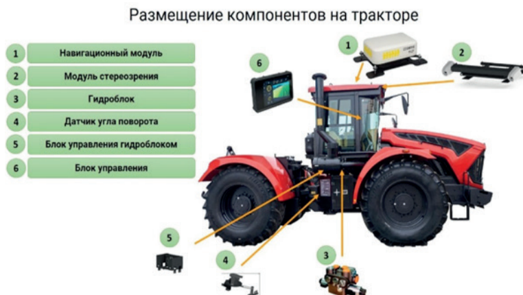
Рисунок 2 - Размещение блоков управления и приборов на БТ
