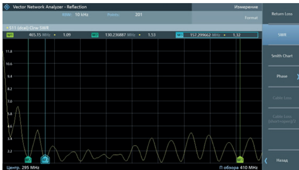
Рисунок 8. Результаты измерения коэффициента стоячей волны
