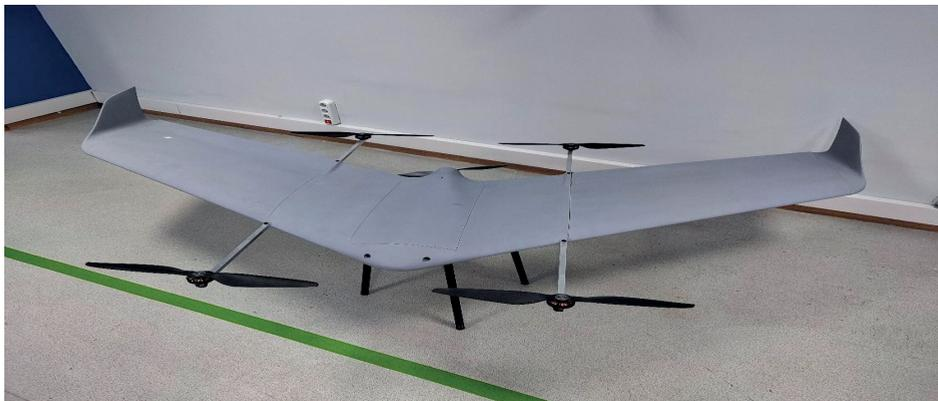
Рис. 3 – Универсальный дрон для мониторинга на основе конвертоплана
