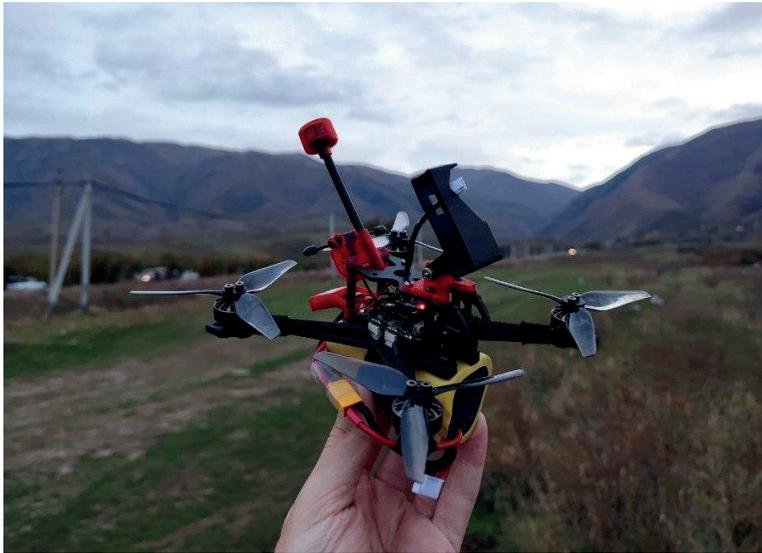
Рисунок 1 – Нанодрон для мониторинга
