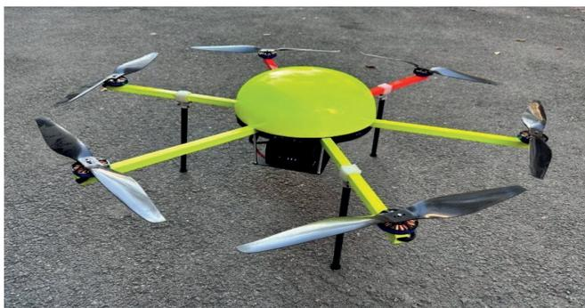
Рис. 2 – Универсальный дрон для мониторинга на основе гексакоптера
