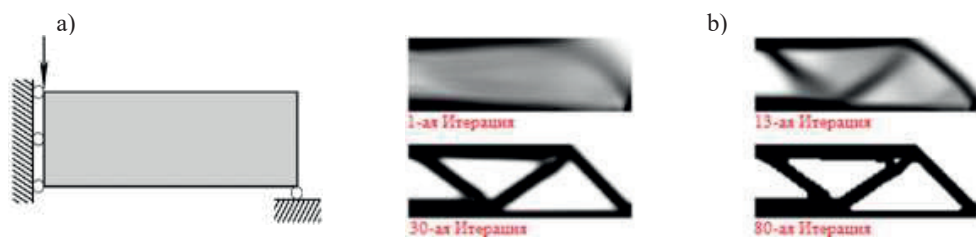
Рисунок 1 – Пример луча MBB: а) область проектирования, граничные условия; и б) промежуточные и окончательные результаты ТО на основе метода SIMP для элементов МКЭ размером 120 \times 40
