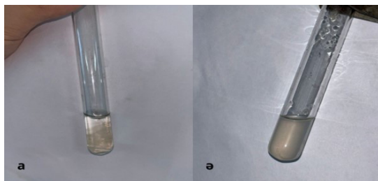
Сурет 8 — Кептірілген балық желімінің суда және қыздырғаннан кейінгі күйі а — суда ісінген желім қиындылары; ә — қыздырғаннан кейінгі еріген және тұтқыр күйдегі желім.
