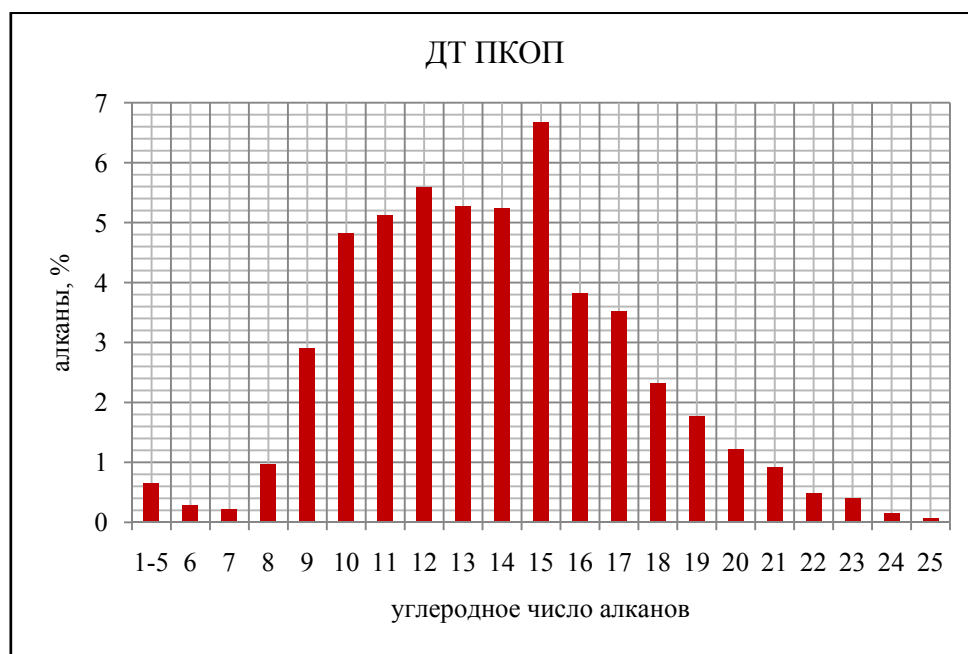
Рисунок 3 – Распределение алканов в ДТ -ПКООП
