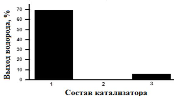
Обозначения: 1 – 1%MoCrGa/ТБГ; 2 – 10% MoCrGa/ТБГ; 3- 5% MoCrGa/ТБГ+ZSM-5+Al<sub>n</sub>(OH)<sub>3n-1</sub>NO<sub>3</sub>.
