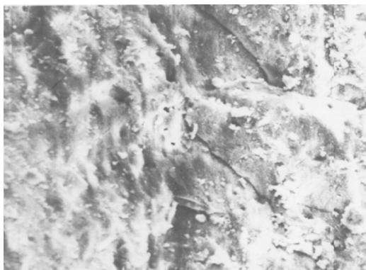
Рисунок 5-Электронно-микроскопический снимок -γ-Al<sub>2</sub>O<sub>3</sub>
