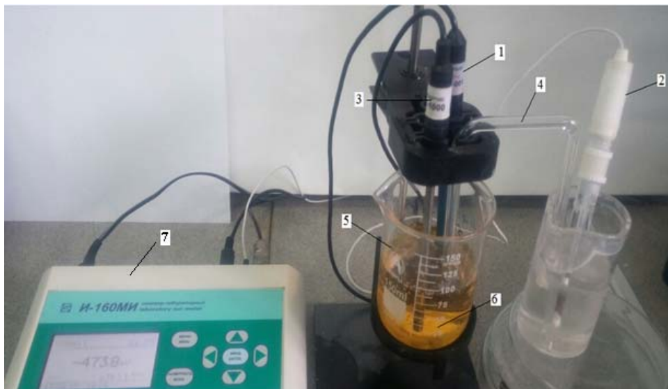
1-сурет – Ионселективті электродтарды қолдану арқылы сульфид-иондары мөлшерін анықтауға арналған қондырғының көрінісі: 1 - анықтаушы электрод (сульфид-ион селективті электрод- хс-sgl.-001,02-58); 2 - көмекші электрод (электрод-AgCl 0,3 М КCl мен толтырылған); 3 - термоматчик ТДЛ-1000; 4 - мостик (көпірше); 5 - химиялық стакан; 6 - зерттелетін ерітінді (құрамында сульфид ионы бар); 7 - иономер
