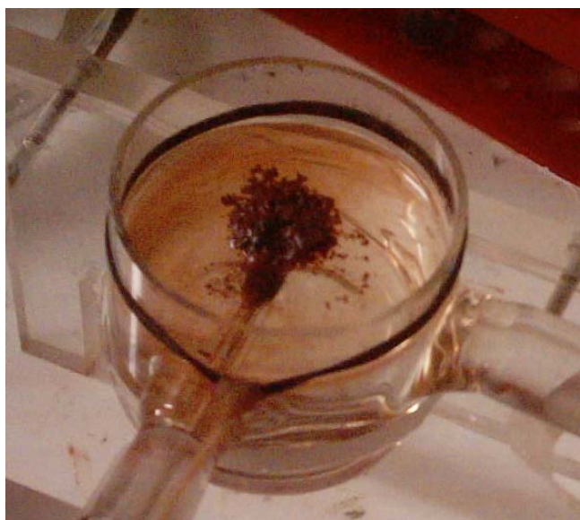
Рисунок 3 – Цвет электролита и порошка селена, осевшего на титановом катоде под действием импульсного тока I = 5 \cdot 10^2 \text{ а} \cdot \text{м}^{-2}
