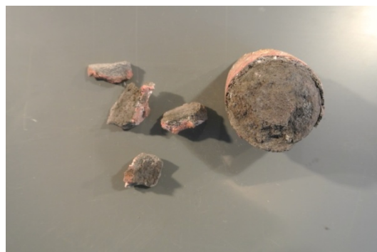
Рисунок 3 – Полученный образец после СВС в высокотемпературной центрифуге
