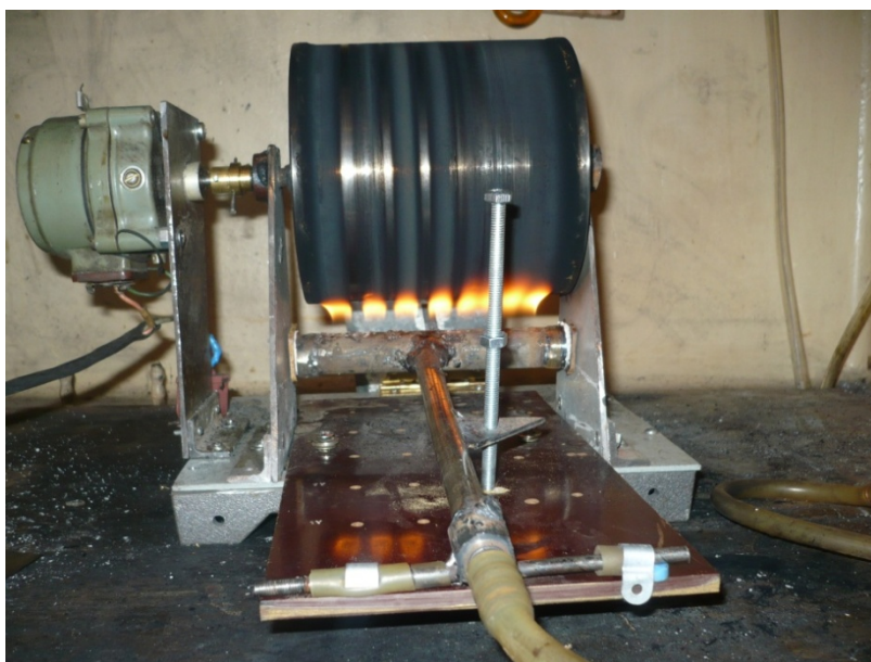
6-сурет – Электр өрісінің реттелуімен супергидрофобты күйені синтездеу процесінің тәжірибелік қондырғысының фотосуреті
