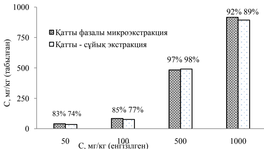
4-сурет – Ластаған топырақтағы мұнай көмірсутектерін қатты фазалы микроэкстракциямен және қатты-сұйық экстракция әдісімен анықтау нәтижелерін салыстыру
