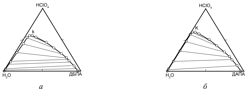
Рисунок 2 – Диаграммы растворимости систем \text{HClO}_4 – вода – амид: а – ДБПА; б – ДАПА
