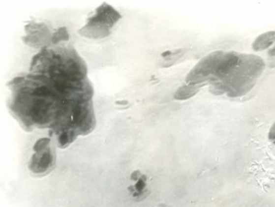
4-сурет. 1%MoCrGa/ТАСБ катализаторының электрондық микроскоп суреті 10-12нм CrO (JCPDS, 6-532), Ga 2 O 3 (JCPDS, 6-529), MoO 3 (JCPDS, 5-508) және Mo 2 C (JCPDS, 11-680)
