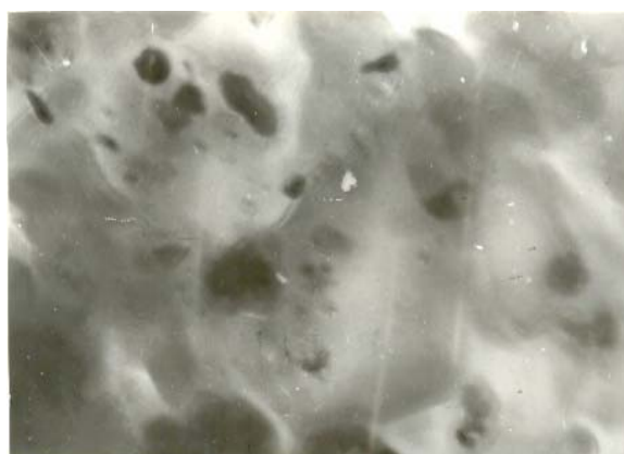
2-сурет – 1%MoCrGa/ТАСБ катализаторының электрондық микроскоп суреті 10-20нм \text{Cr}_3\text{O}_4 (JCPDS, 12-559), \alpha\text{-Ga}_2\text{O}_3 (JCPDS, 6-503), \text{Mo}_5\text{O}_8 (JCPDS, 9-159) және \gamma\text{-MoC} (JCPDS, 8-384)
