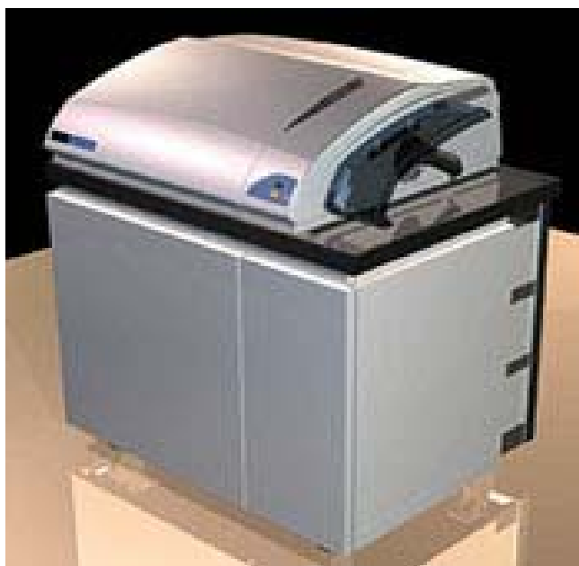
Рис. 1. Квадрупольный масс-спектрометр с индуктивно-связанной плазмой ELAN 9000
