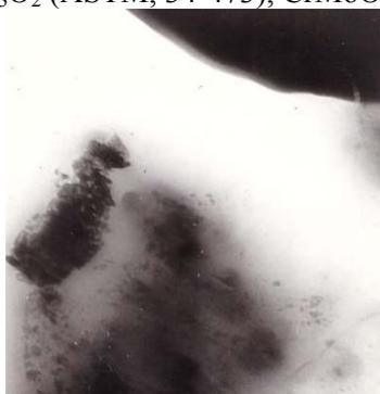
3 сурет - 5%MoCrGa/ТБ+ИК-30 өңделген катализатордың электрондық микроскоп суреті.
