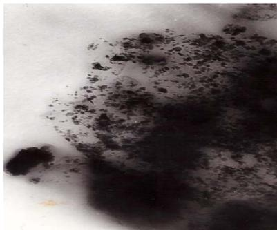
2 сурет - 5%MoCrGa/ТБ+ИК-30 өңделген катализатордың электрондық микроскоп суреті.
