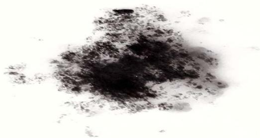
1 сурет - 5%MoCrGa/ТБ+ИК-30 бастапқы катализаторының электрондық микроскоп суреті.  $\alpha$ -Ga<sub>2</sub>O<sub>3</sub> (ASTM, 6-503), Cr<sub>0,17</sub>Mo<sub>0,83</sub>O<sub>2</sub> (ASTM, 34-473) және CrO (ASTM, 6-532), Mo<sub>4</sub>O<sub>11</sub> (ASTM, 13-142).
