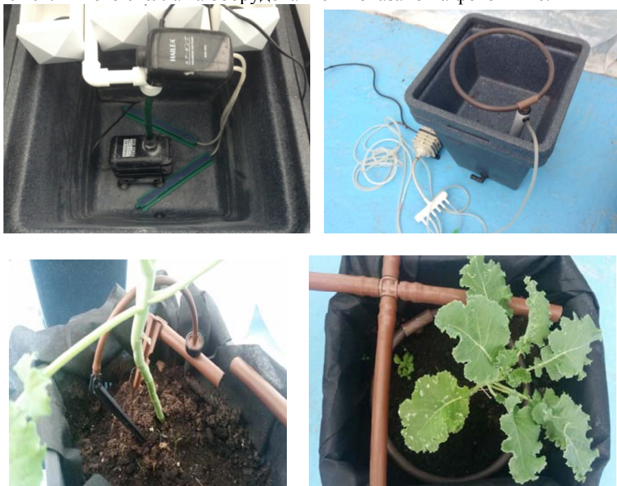
Фото 2 – Емкость, насос подачи воды и питательного раствора, а также система капельного полива
