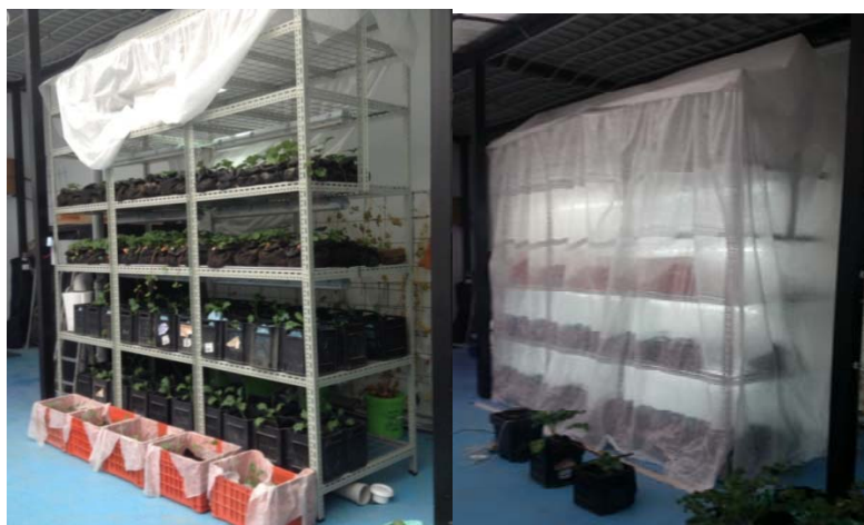
Слева – чехол для регулирования газовой среды поднят для обслуживания, справа – чехол укрывает стеллаж, создавая в зоне стеллажа оптимальный микроклимат для растений.
