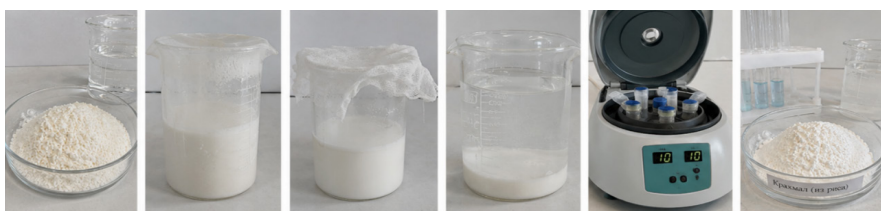
Сурет 4 – Байдалы күрішінен күріш крахмалын алу сатылары
