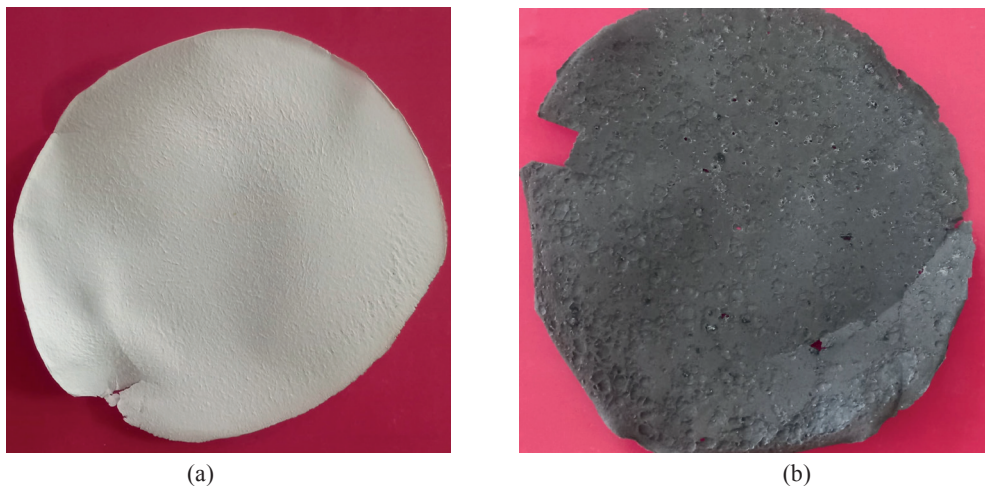
Сурет 1 – Наноцеллюлоза негізіндегі мембраналар: (a) таза мембрана; (b) модификацияланған мембрана.
