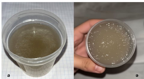
Сурет 7 — Балық желімінің физикалық күйінің өзгеруі а — сұйық ерітінді; ә — гель тәрізді масса
