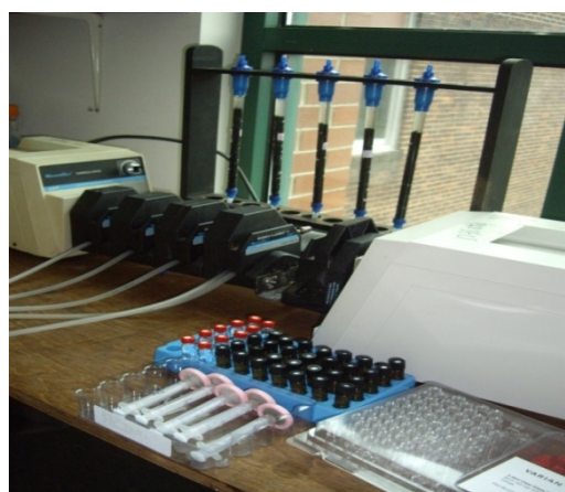
3-сурет – БТЭК ерітіндісін тазалау үдерісі: 1, 2 – шунгит + микроағзалар; 3, 4, 5 – шунгит; 6 – БТЭК; 7, 8 – насос; 9 – су
