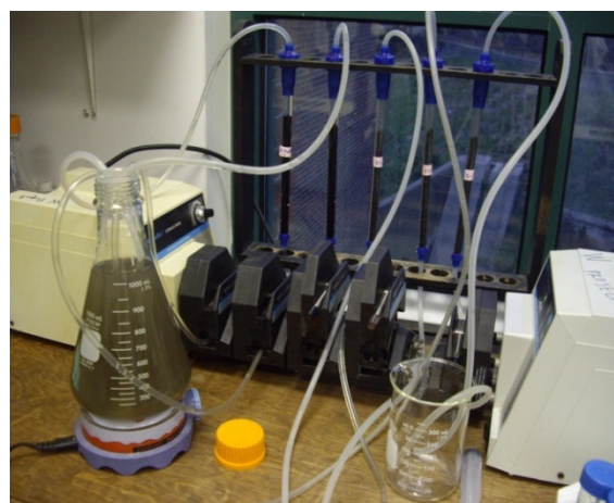
2-сурет – Микроағзаларды шунгитте иммобилизациялау: 1, 2 – шунгит; 3 – насос; 4 – қоректік орта+микроағзалар
