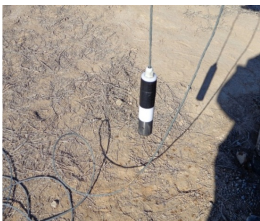
Рисунок 2.3 – Датчик уровня для закачной скважины
