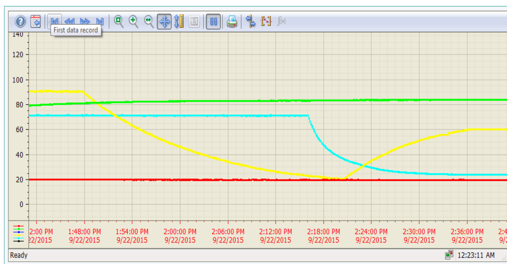
Рисунок 2.6 – График экспериментального снижения уровня выщелачивающих растворов в закачной скважине и ее заполнения при увеличении расхода.
